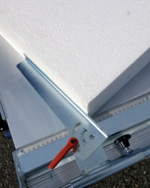
Gehrungswinkel-Anschlag Mitre square stop for bevel cuts
