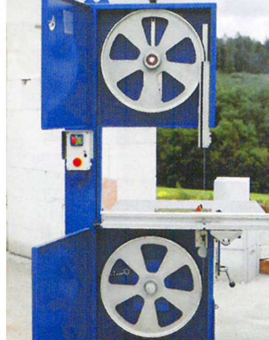
Sägerollendurchmesser 500 mm Saw wheel diameter 500 mm
