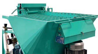
Nouveau design de trémie, plus volumineuse (140 l)
