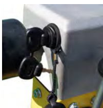
Boîtier de démarrage électrique
