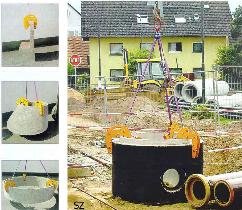
Pince à regards béton Klem voor betonnen inspectieputten
