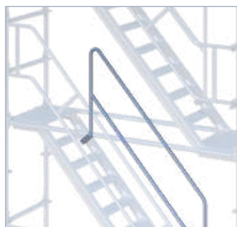
Montage direct aan de trap
